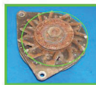
Chybí kolo ventilátoru
