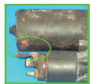
Upadnutí kabelu v důsledku koroze
